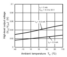
Fig. 13.2.6 (V<sub>CC</sub>-V<sub>OH</sub>) - T<sub>a</sub>
